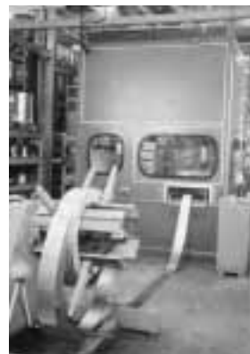
Enceinte intégrale d'une presse automatique.
