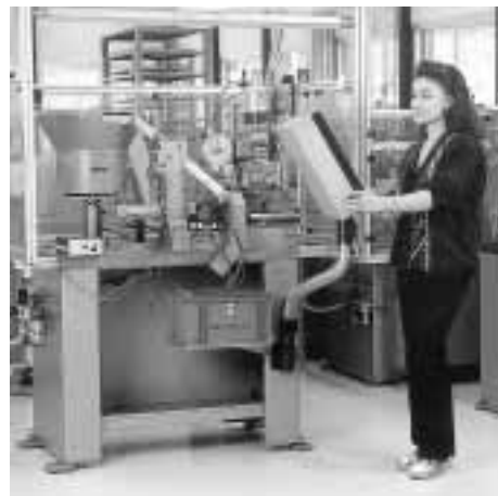
Figure 8: panneau de contrôle à hauteur de vue et à portée de main.
