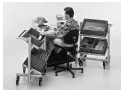
Figure 6: un repose-pied réglable en hauteur et inclinable permet une posture adéquate des jambes lorsque la table de travail est haute ou à un poste de travail combiné assis-debout.
