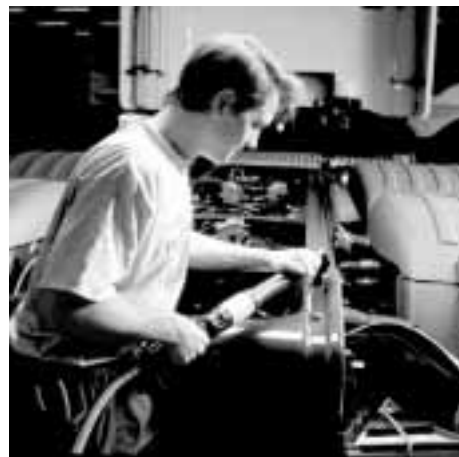
Figure 9: ce tournevis coudé permet de travailler en adoptant une posture correcte.
